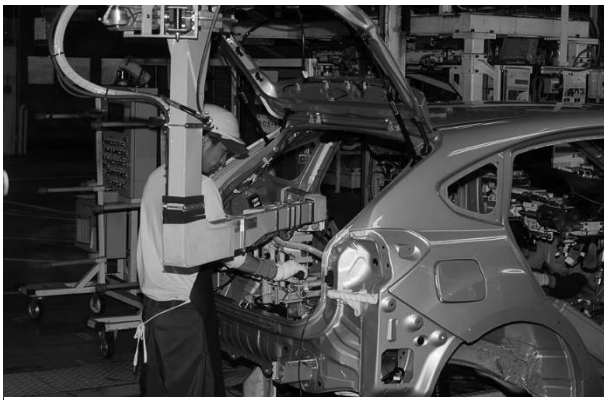
自動車工場のボディ組立工程のスポット機による組立作業
