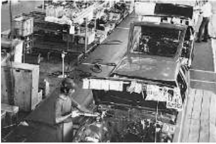
トヨタ生産方式で組み立てを行う自動車工場
